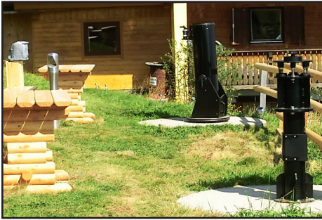
Zwei eigene Betonaufstellplattformen mit einer Teleskopstandsäule
